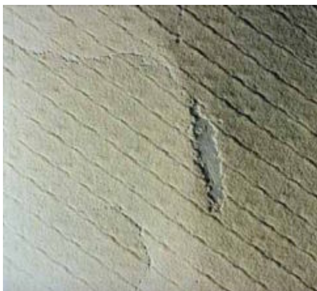
图 9-6 已经结垢的膜表面（进水流道网格在垢类上形成的压痕清晰可见）
