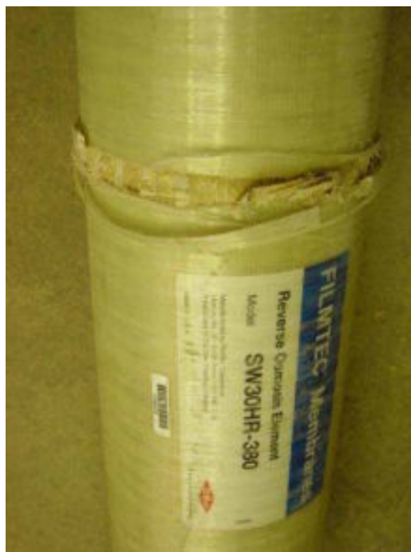
9-9 膜表面缠绕玻璃钢高压差破裂
