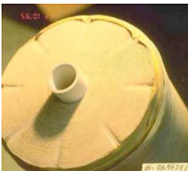
图 9-10 生物污堵所致高压差将流道网格冲出
