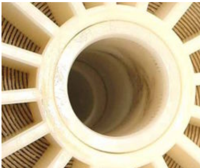
图 5. 第 5 号压力容器 1 号膜元件发生 O 形密封圈磨损的照片
