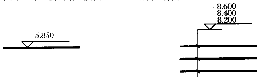
图 2.3.5-1 平面图中管道标高标注法
